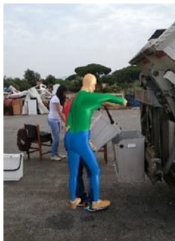
Figura 3: l'immagine mostra la ricostruzione fatta con il software 3DSSPP dello svuotamento del mastellino nel cassone omologato
