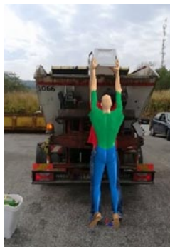
Figura 2: l'immagine mostra la ricostruzione fatta con il software 3DSSPP dello svuotamento del mastellino nella parte posteriore del mezzo di trasporto
